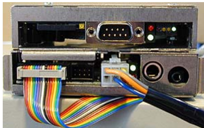
DIVA Base und Option4 montiert 1. SIM Halter, Balken und Status LEDs
